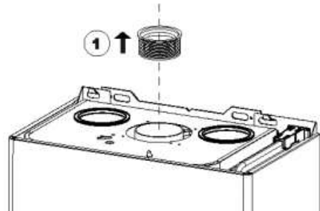
Рис. 6. Установка уплотнения коаксиального дымохода
